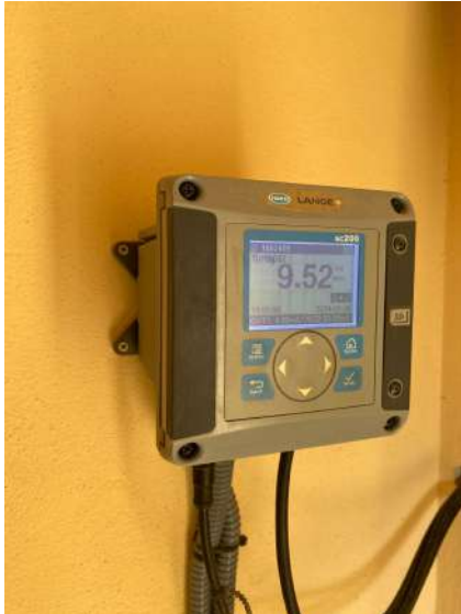
5 - Turbidímetre automàtic Ses Mosqueres
